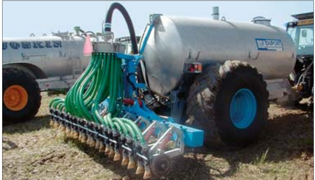
Equipo de inyección de purines al suelo.
